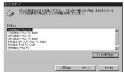
③ウィンドウズ95のモデムウィザードの画面。接続速度によってインストールするドライバーが違ふ
