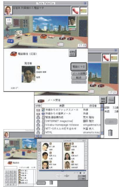
▲画面2. NTTの開発したCTIシステムの一例。電子メールも、組織内部の電子メールも、外線の電話のボイスメールやファクシミリも同じ「メール受信」の画面で管理している。情報の形態の違いによって、文字を表示したり、音声再生のプレーヤーが起動したりする。
