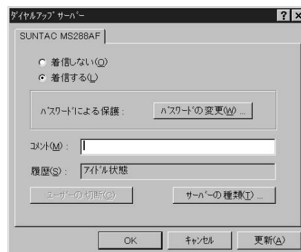
図2 ダイアルアップサーバーの設定シート。「着信する」を選び、パスワードなどの設定をする。
