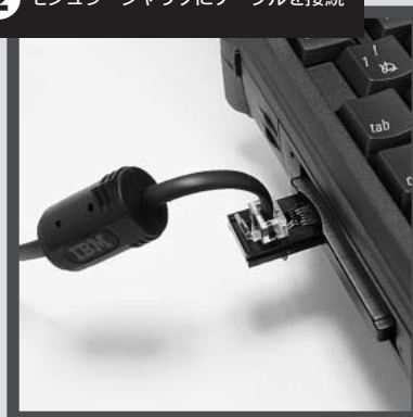
2 モジュラージャックにケーブルを接続
