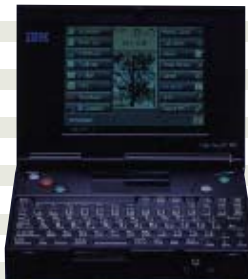
IBM Palm Top PC110 日本IBM (TEL.0120-04-1992) オープン価格 重さ：0.63kg (リチウムイオン・バッテリー込み) バッテリー駆動時間：1.3～3時間 対応電圧：100V
