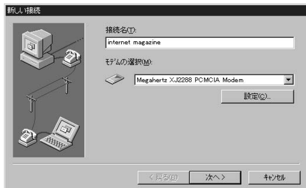
図4 マイコンピュータからダイヤルアップを選び、「新しい接続」を選ぶとダイヤルアップ先の設定が始まる。
