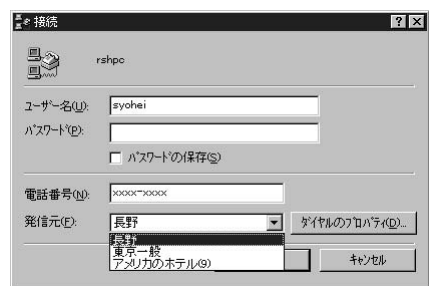
図8 接続先internet magazineのアイコンを右クリックして「接続」を選択するとこの画面に。パスワードを入力するとダイヤルを始める。
