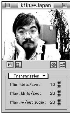
1 設定操作パネルのメニュー「Transmission」で送信時のバンド幅の上限下限を設定する。図は28.8Kbpsモデムの場合。
