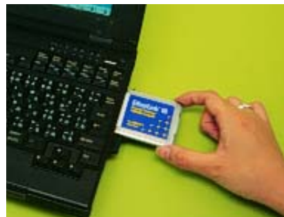
写真① プラグアンドプレイ対応のPCカードタイプのイーサネットカードを入れる。すでに入れたことのある種類のカードならダイアログボックスが表示され、即利用可能。使ったことのないカードならドライバーのインストールが始まる。
