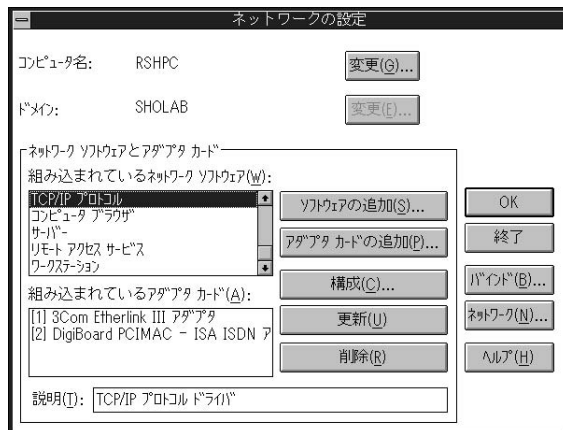
図2 「ネットワークの設定」ウィンドウ。組み込まれているカードアダプターの表示や追加、ソフトウェアの管理などはこちらで行う
