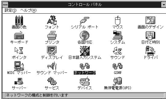
図1 WindowsNT3.5 Serverのコントロールパネル。ネットワークのアイコンをダブルクリックして起動すると、ネットワークの設定になる
