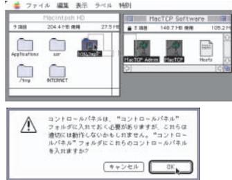
MacPPPとMacTCPをCD-ROMからシステムフォルダにコピーする。MacPPPとMacTCPのアイコンを「システムフォルダ」の上までドラッグして、マウスボタンを離せばOK。システムフォルダに入れていいかどうかを確認するメッセージが表示されるので『OK』ボタンを押す。コピーしたら、再起動する。
