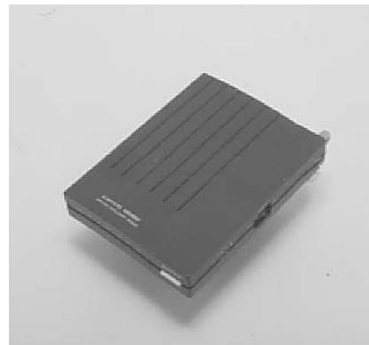
14400bpsのボイスFAXモデムが人気のサン電子が新発売したこのモデムは、V.34とV.Fastの両方をサポートしている。購入したときからV.34が使えるのでアップグレードの費用が不要なうえに、定価が44,800円。今回紹介したなかでもとくに安価なモデムと言えるだろう。
