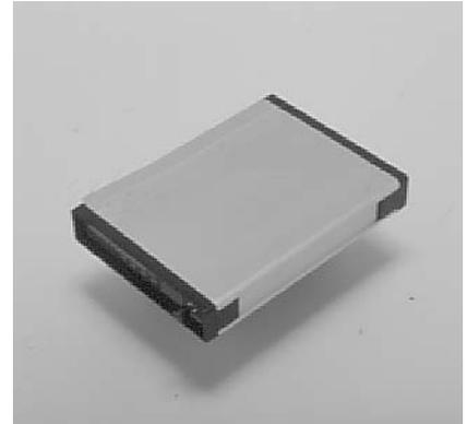
プロトコルはMNP5、V.42bis、MNP10に対応している。電源はACアダプタで供給する。モデム・パソコン間の通信速度は最大115Kbpsをサポートしている。
