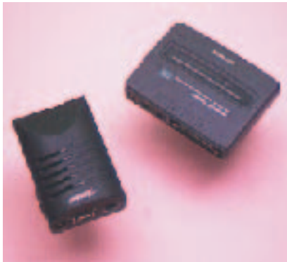
写真 左 ポケット型TA (LinkBoy、BUG社製) 右 14400bpsモデム (PV-PF144、アイワ製)
