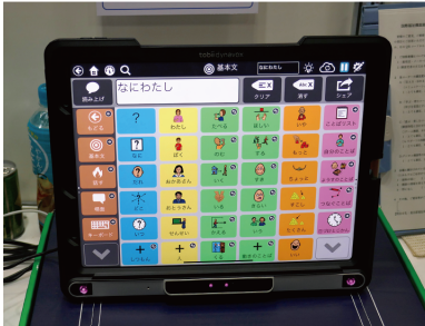
iPadに視線入力センサーとアプリを組み合わせた会話ツール
