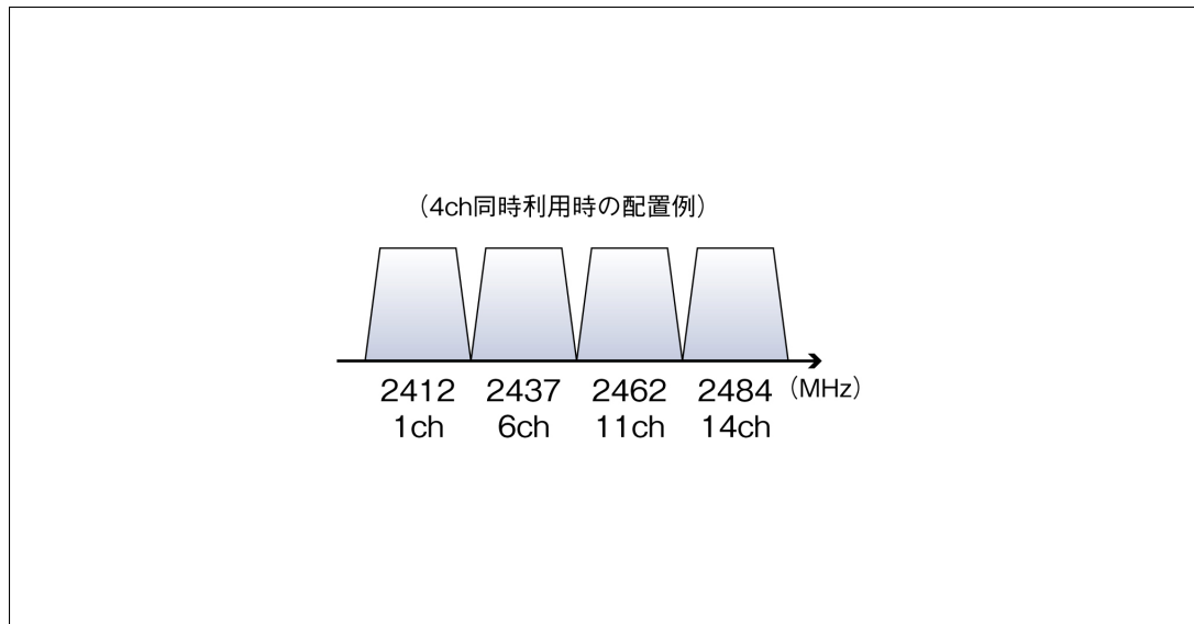
資料5-3-6 2.4GHz帯における無線LANチャンネル配置の一例
